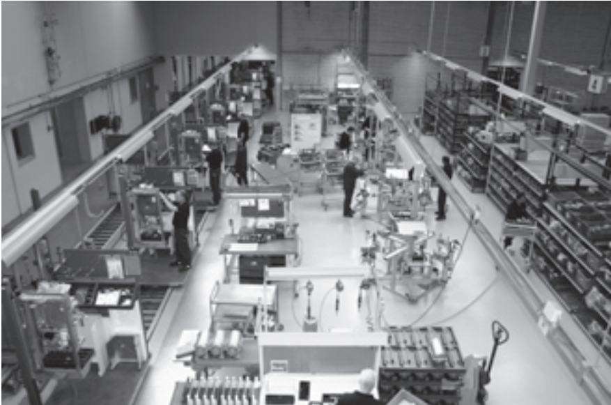
Figuur 4.1: Bij Nefit te Buinen kunnen ze, door toepassing van de Lean Principes, de al verdubbelde productie, nogmaals verdubbelen op het oorspronkelijke vloeroppervlak
